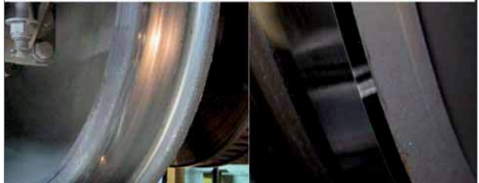
Geometría y vista de la superficie de rodadura de una rueda antes y después del torneado.
